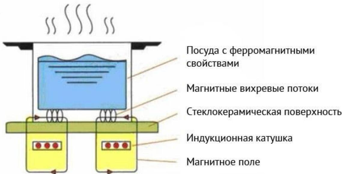
На рисунке схематично изображён принцип работы индукционной плиты. От чего получает тепло вода в кастрюле при использовании индукционной плиты?
