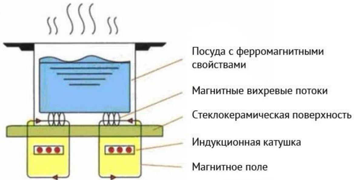
На рисунке схематично изображён принцип работы индукционной плиты. От чего получает тепло вода в кастрюле при использовании индукционной плиты?
